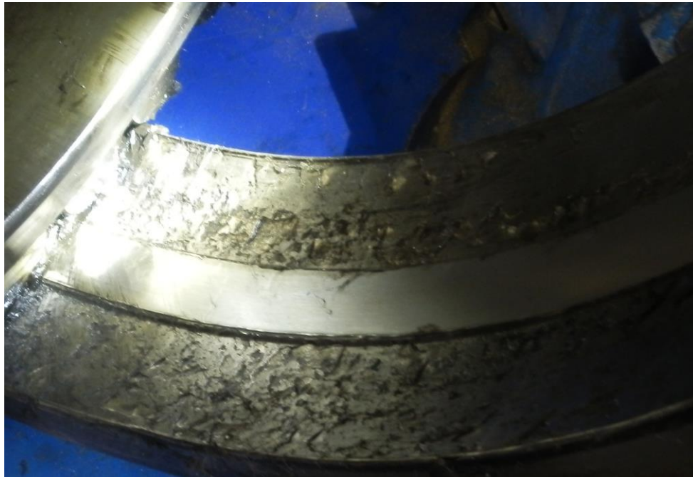
Рис.5. Выкрашивание металла на дорожке качения наружного кольца
