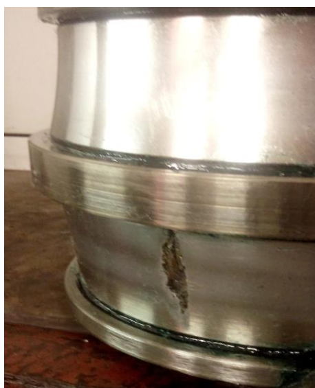
Рис.8. Выкрашивание металла на одной из дорожек внутреннего кольца подшипника
