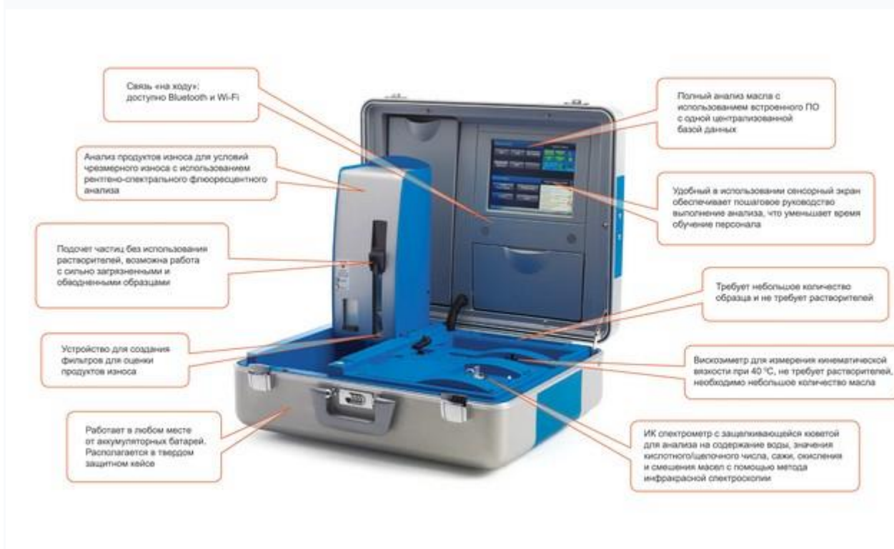
Рис. 4. Новая минилаборатория для анализа масел. Обучение работе проводит компания BALTECH
