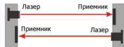
Рис. 3.7 Двойной лазер, использующий метод обратных индикаторов
