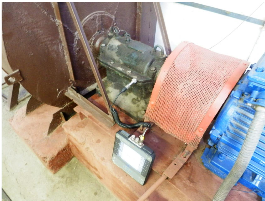
Рис.6. Применяемая аппаратура при методе «трёх точек».
