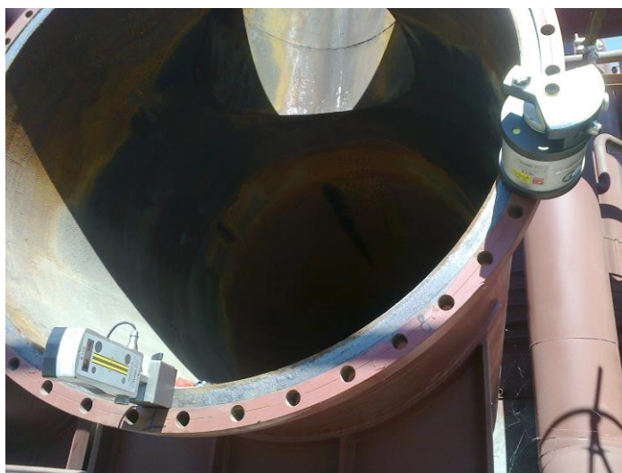
Рис.1. Излучатель и приёмник на корпусе аппарата
