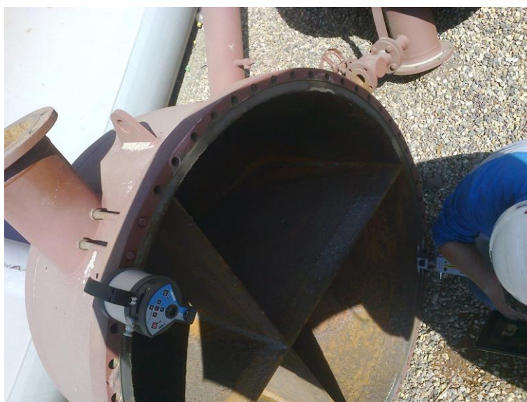
Рис.2. Излучатель и приёмник на крышке аппарата.
