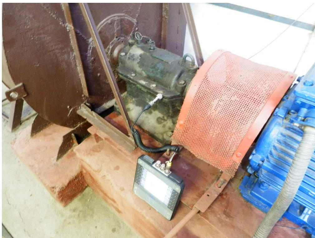
Рис.6. Применяемая аппаратура при методе «трёх точек».
