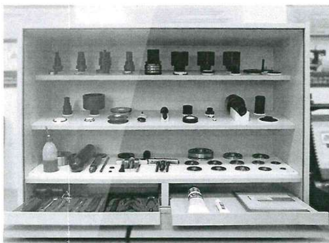
Учебный стенд BALTECH Bearing монтаж/демонтаж подшипниковых узлов
